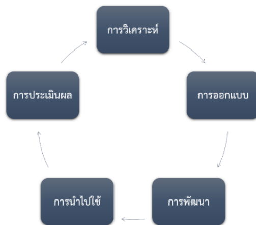
ภาพที่ 1 วงจรการพัฒนาซอฟต์แวร์ (System Develop Life Cycle)
